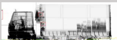
Получение рентгеновского изображения Eagle T60 с дополнительным режимом CabScan и встроенной функцией обнаружения радиации
